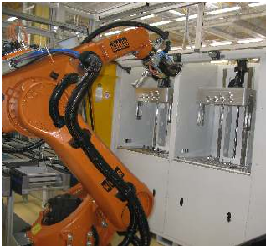
Roboter bestückbare Doppelkammeranlage
