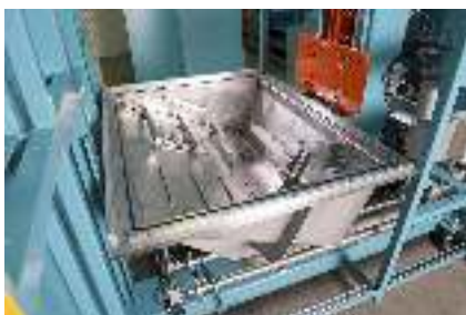
Roboter / Manuell bestückbare Doppelkammeranlage
